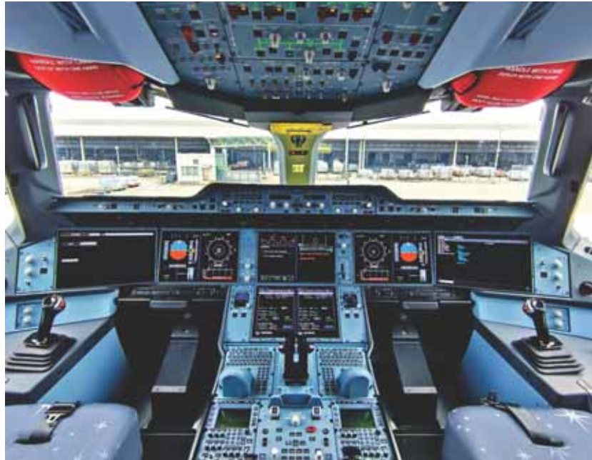
In der Luft- und Raumfahrt werden Redundanzen von Anfang an mitgedacht, wie schon ein kurzer Blick ins Cockpit aufzeigt: Alles ist doppelt vorhanden.
