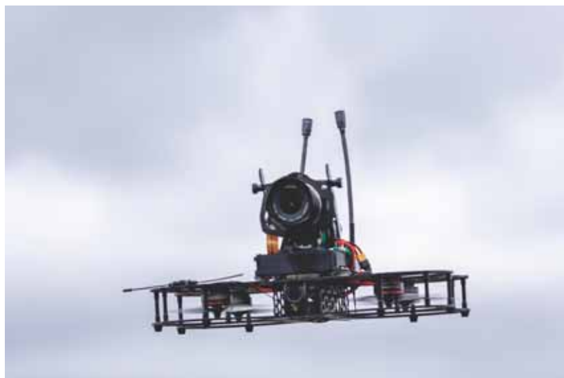
Drohnen mit professioneller Kameraausrüstung ermöglichen die präzise Inspektion von Gleisanlagen und Infrastruktur aus der Luft – schnell, sicher und ohne Betriebsunterbrechung.
