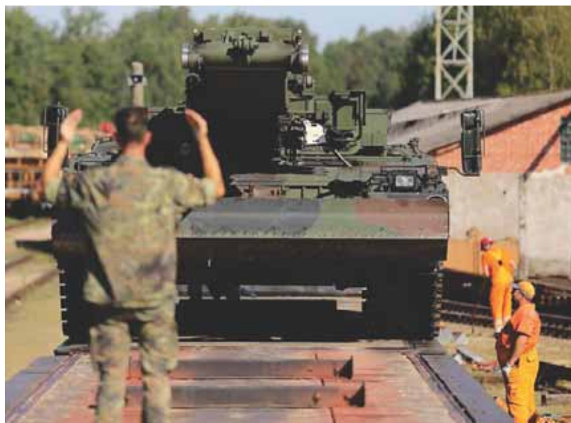
Der Transport von Militärtechnik ist strategisch wichtig: Auch Gerät wie der Brückenlegepanzer Leguan (hier ohne Brücke) wird per Bahn transportiert.
